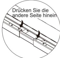
Drehen Sie zunächst die M6 Schrauben (B) mit einem 4x4 Inbusschlüssel (F) unvollständig in den Tragbalken (4), d.h. ziehen Sie sie nicht fest. Schieben Sie als Nächstes eine Seite der Kabelführungsplatte (3) in die Schrauben (B), dann die andere Seite. Ziehen Sie zum Schluss die Schrauben (B) mit dem 4x4 Inbusschlüssel (F) fest.
